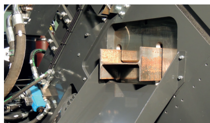
Cisaille haute vitesse pour profilés High speed shearing unit for profiles Hochgeschwindigkeitsschere für Profile
