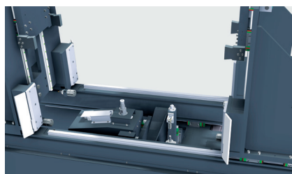
Unité de marquage - fraiseuse 4 ème axe Milling and marking unit on 4th-face 4-seitiges Fräsen und Markierenheit
