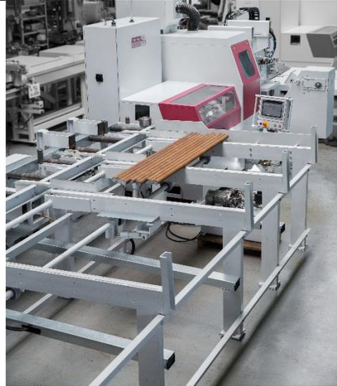
Rundstäbe und Rundrohre werden meist im Bund angeliefert und auf das robuste Materiallager des Magazins gelegt. Dort wird das Bund geöffnet und die Stäbe als Lage auf dem Magazin verteilt.
