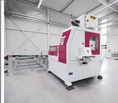
Die Hochleistungs-Metallkreissäge HCS 150 E ist die Basis für Massenproduktion mit höchster Ausbringung und Qualität. Sie trennt Vollmaterialien und Rohre bis 152,4 mm (6 Zoll) Durchmesser oder Vierkantmaterial bis 130 x 130 mm Kantenmaß.
