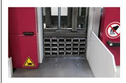
Ein Doppelspannstock bietet Prozesssicherheit – gerade bei Einzelschnitten oder beim Sägen von Lagen und Paketen.
